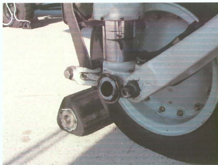
Particolare assale del ruotino anteriore B737.
